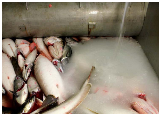
Figur 2.3 Isslurryanlegget om bord i M/S Loran til venstre, isslurry i ublødningstank til høyre.
